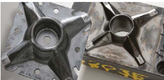
بالا - قطعه پرسی با تولاکس ۴۴ برای پایه یخچال الکترو لوکس، ۱/۶۰۰/۰۰۰ قطعه ساخته شد. پایین - قالب شکل دهی با تولاکس ۴۴. تعداد قطعات تولیدی از قالب ساخته شده با تولاکس ۴۴، سه برابر تعداد قطعات تولیدی از قالب ساخته شده با D2/1.2379 (60 HRC) است.
