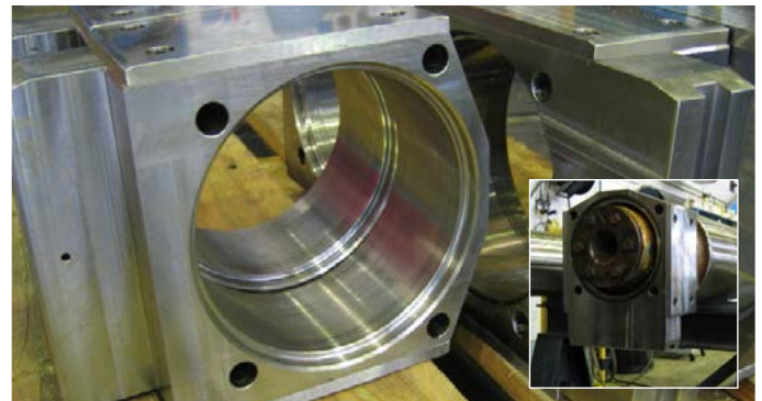
اتاق یاتاقان- تولاکس ۳۳ ثابت ابعادی دارد و ماشین کاری جداره های نازک را آسان می سازد.
