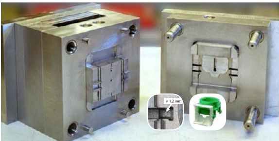
بالا - لیوان پلاستیکی تولید شده با ۱۵٪ هزینه کمتر نسبت به H13/1.2344. پایین - روکش برقی PA6 تولاکس ۴۴ به منظور کاهش زمان ساخت، جایگزین AISI 420 گردید.
