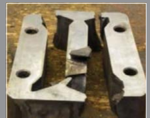
۱.2379/2 با سختی ۶۰ راکول سی ایجاد ترک بعد از ۱۰/۰۰۰ ضرب تولید
